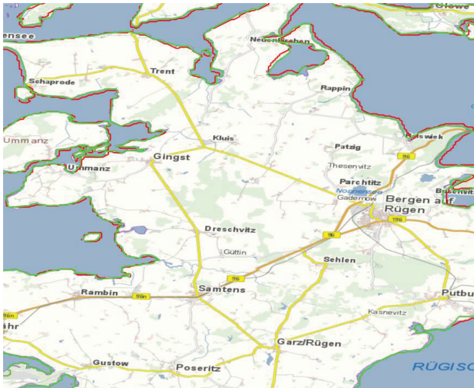
Abbildung 5-15 Ein Ausschnitt der Rügenischen Boddenlandschaft und die Küstenlinie nach den GSHHS-Daten in Rot und nach neu berechneten Küstenpunkten in Grün
