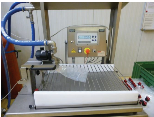
Abbildung 5: Abfüllanlage mit BiB-Beutel
