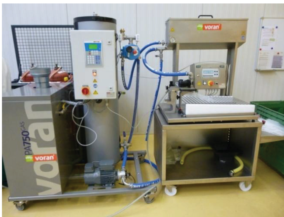
Abbildung 4: Pasteurisations- und Abfüllanlage
