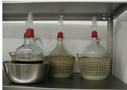
Abbildung 6: Apparatur der Vorvergärung
