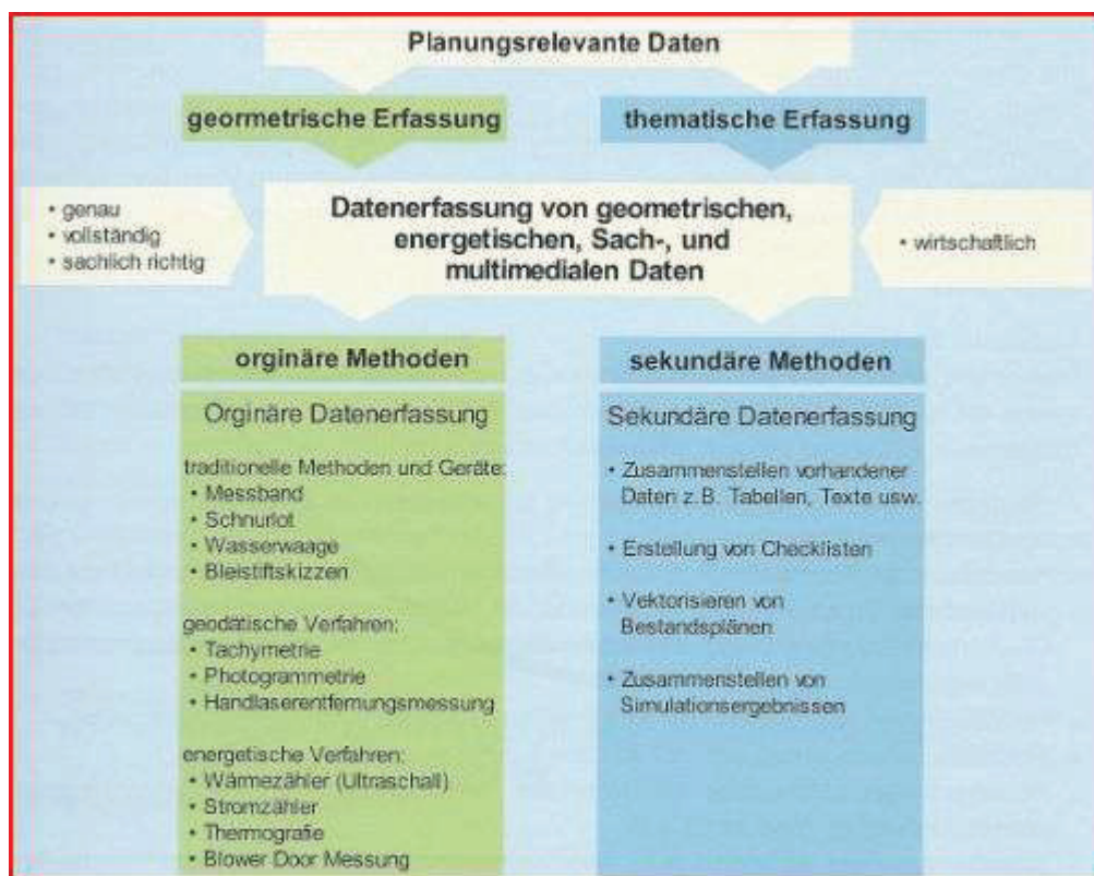
Abbildung 2 Methodik der Bestandsaufnahme bei Gebäudesanierung 13
