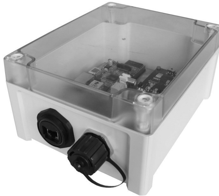
Abbildung 8.2.: Erster Prototyp des Messclients im Kunststoffgehäuse
