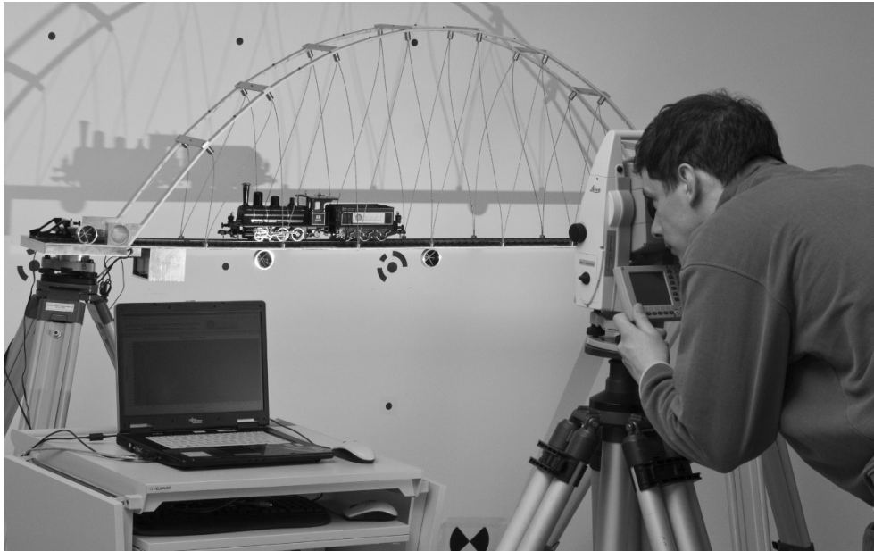
Abbildung 4.2.: Testmessungen mit DABAMOS an einem Brückenmodell (Bild: THOMAS MANDT, HOCHSCHULE NEUBRANDENBURG)
