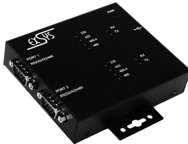
Abbildung 6.9.: Beispiel für einen USB-Konverter mit zwei Ports für RS-232, RS-422 und RS-485 [EXSYS VERTRIEBS GMBH, 2013]
