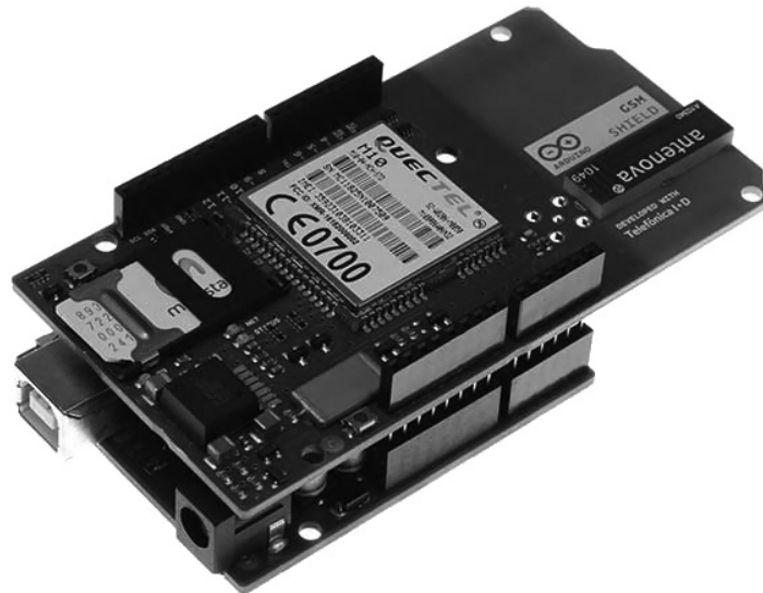
Abbildung 6.1.: Ein GSM Shield mit eingesetzter SIM-Karte, das auf einem Arduino Uno steckt [ARDUINO, 2013]
