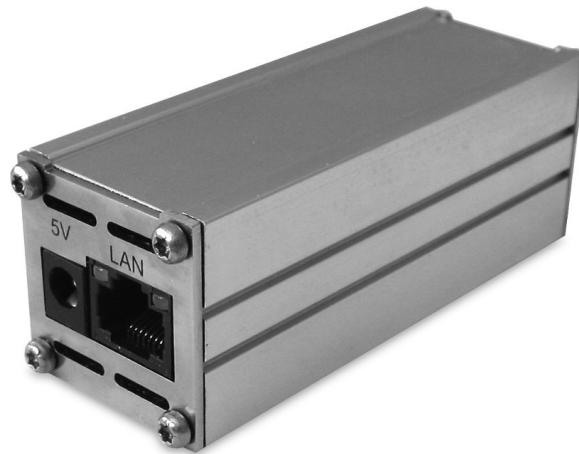
Abbildung 6.6.: Das Triometer ALL3418 von ALLNET dient der netzwerkbasierten Erfassung von Temperatur und Luftfeuchte. Die Messwerte des Sensors werden als HTML-Seite über HTTP ausgegeben. Die Spannungsversorgung ist optional auch über Power over Ethernet möglich.
