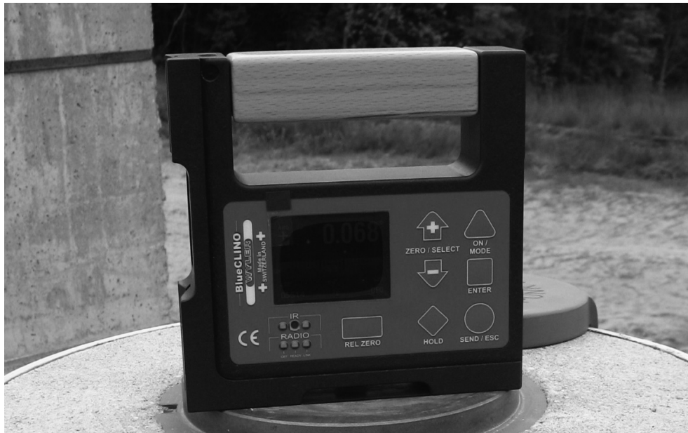
Abbildung 6.5.: Das Neigungsmessgerät BlueCLIO von Wyler ist mit einer Bluetooth-Schnittstelle ausgerüstet
