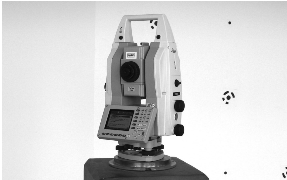
Abbildung 9.1.: Das Präzisionstachymeter Leica TM30 kommt bei der praktischen Erprobung des Messclients im Labor und auf dem Dach des Fachbereichs Landschaftswissenschaften und Geomatik zum Einsatz
