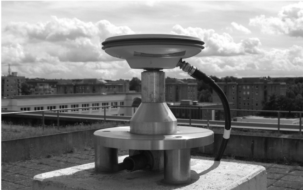
Abbildung 3.1.: Die GNSS-Antenne Leica AS10 unterstützt GPS, GLONASS, Galileo, Compass und SBAS und wird für einzelne Referenzstationen oder RTK- und Monitoringnetze verwendet
