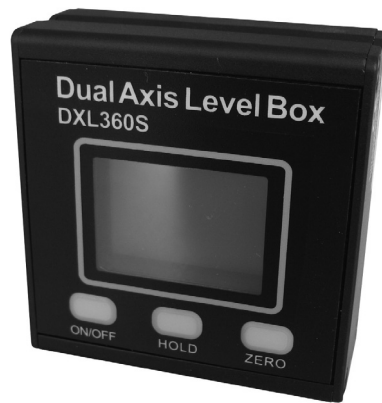
Abbildung 3.4.: Bluetooth-fähiger Low-Cost-Zweiachsneigungssensor DXL-360S mit einer Genauigkeit von \pm(0,08^\circ + 1\%) , bei einer Auflösung von 0,01^\circ
