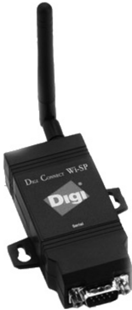
Abbildung 6.8.: Ein Serial Device Server von Digi International. Der Adapter wird an die 9-polige D-Sub-Buchse einer RS-232/422/485-Schnittstelle angeschlossen und überträgt Daten kabellos per 802.11b auch über größere Distanzen. Die Konfiguration erfolgt über ein Web-Interface. [DIGI INTERNATIONAL INC., 2013]
