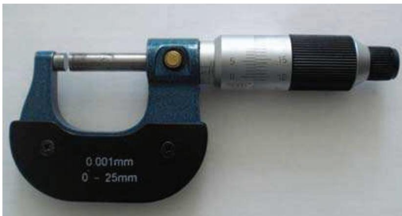
Abbildung 12: Bügelmessschraube
