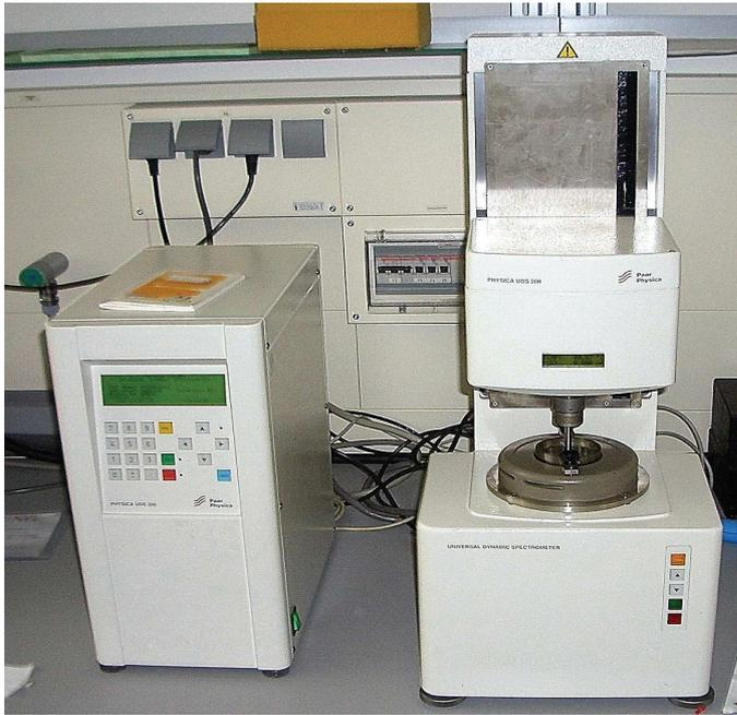
Abbildung 15: Rotationsrheometer der Firma Physica
