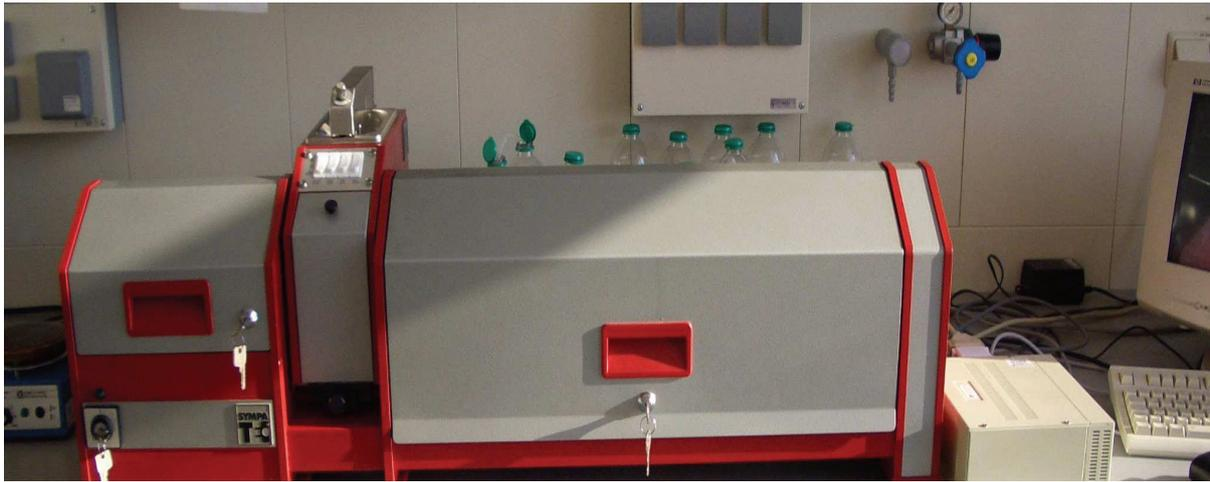
Abbildung 13: Laserbeugungsspektrometer
