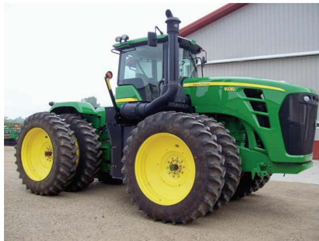
Abbildung 5: Traktor des Herstellers John Deere, Modell 9230, Eigengewicht 15,5 Tonnen, Radstand 3,5 Meter (9)
