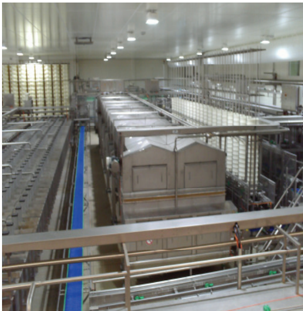
Abb. 12: Draufsicht Verweilstrecke für Rundlaibe
