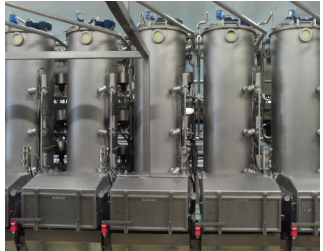
Abb. 8: Das Multi Column Drainagesystem
