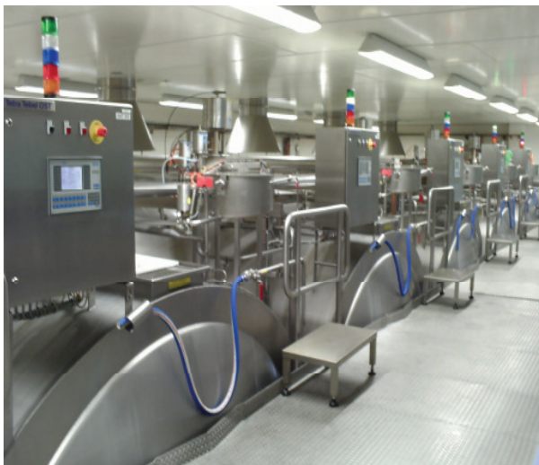
Abb. 6: Käsefertigerbühne mit Steuerelemente
