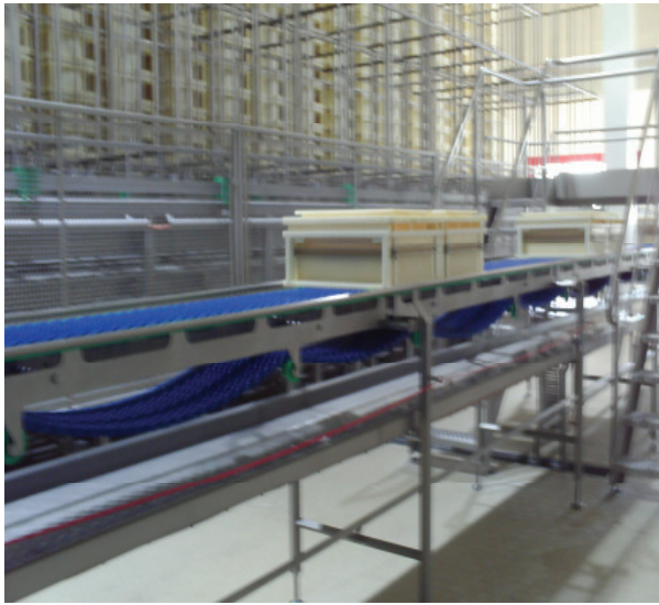
Abb. 10: Transportband der Käseformen nach dem Pressen
