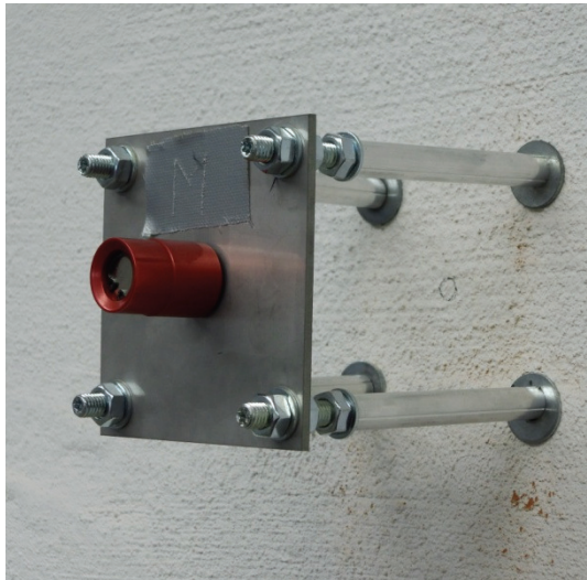
Abbildung 40: Wandhalterung am Messpunkt M
