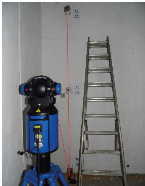
Abbildung 49: Angestrebter Strahlenverlauf nach der Ausrichtung der Spiegelkonstruktion
