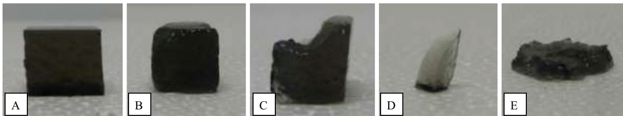
Abb. 17: Kategorien der Agarwürfel nach der Scherbeanspruchung
