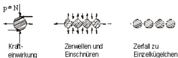
Abb. 6: Fettkugelzerfall beim Homogenisieren (Kessler 1992)
