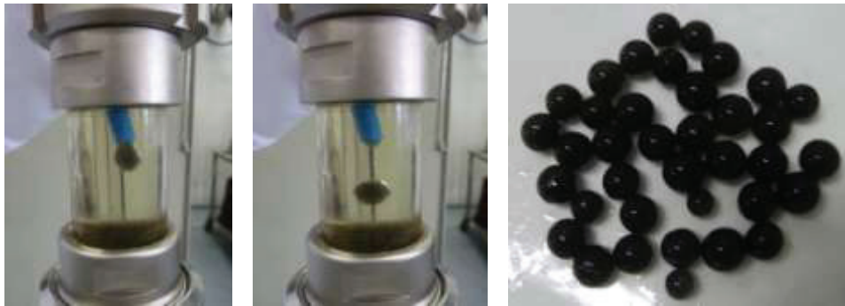
Abb. 12: Herstellung der Agarkugeln
