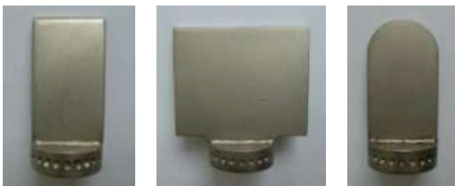
Abb. 15: Rührblätter des modifizierbaren Rührorgans
