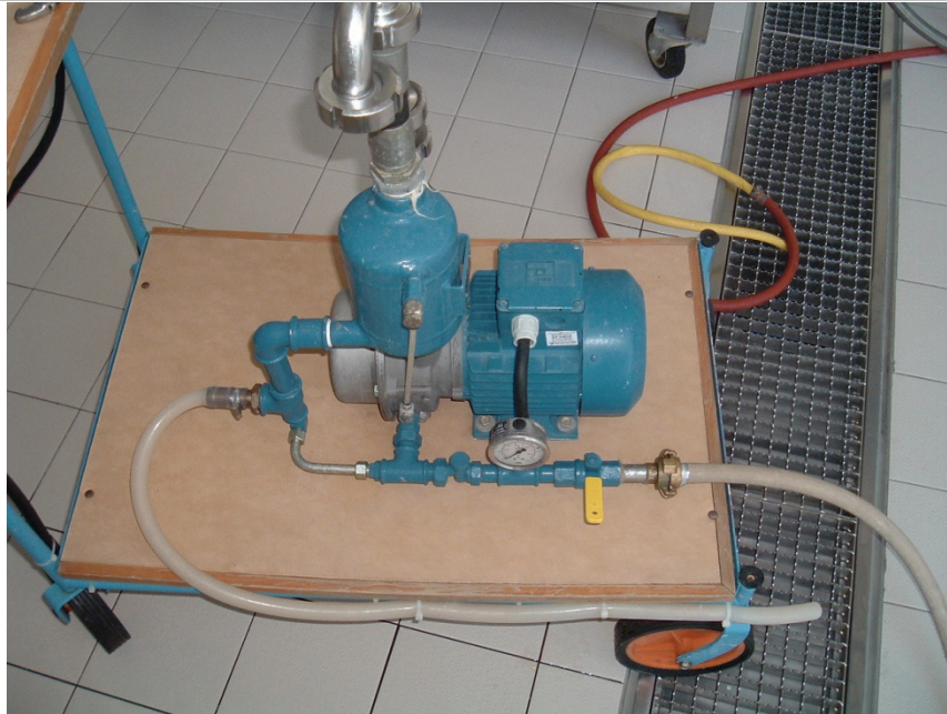
Abbildung 16: Wasserringvakuumpumpe Typ 35000374 – 244, Siemens Hinsch GmbH, Battenberg, Deutschland
