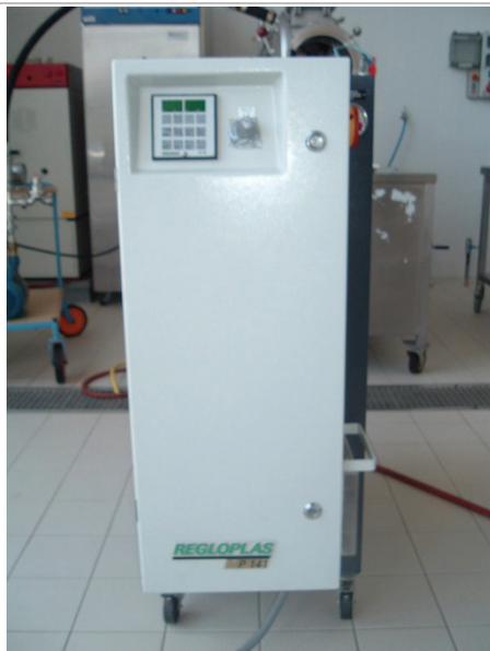
Abbildung 17: Temperiergerät P141, Firma Regloplas, St. Gallen, Schweiz
