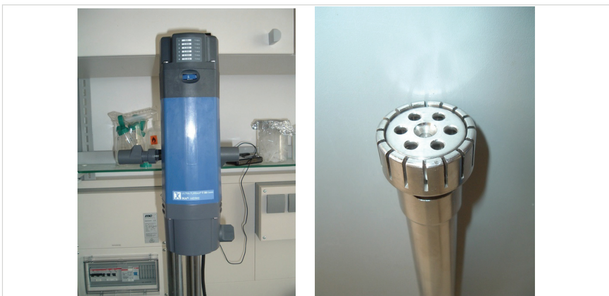
Abbildung 19: Darstellung Ultra Turrax T-50 und dazugehöriger Scherkopf G45, IKA Werke, Staufen, Deutschland
