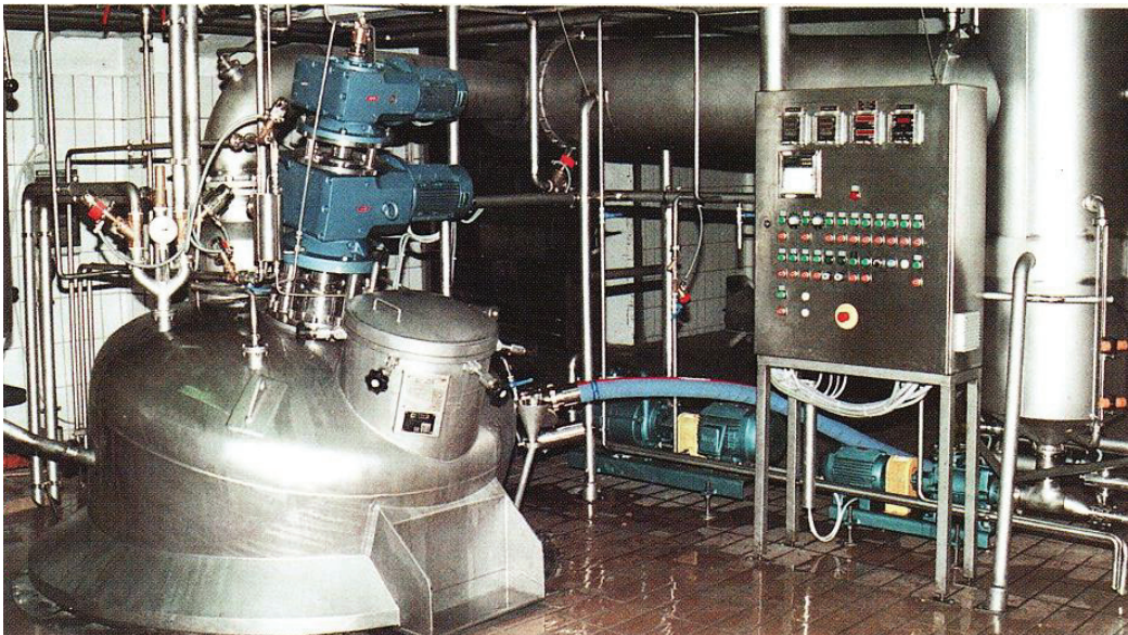
Abbildung 1: Vakuumverdampfer Typ ZVAG (ConsulteC Engineering, 2012)
