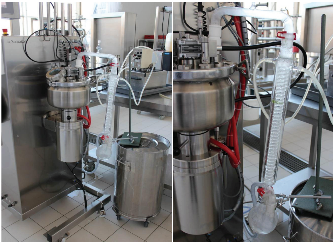
Abbildung 19: Aufbau des Somakon Labormischers mit Graham-Kondensator
