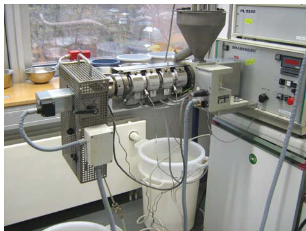
Abb. 26: Extruderzylinder mit Dosiertrichter, Heizelementen und Schneidevorrichtung
