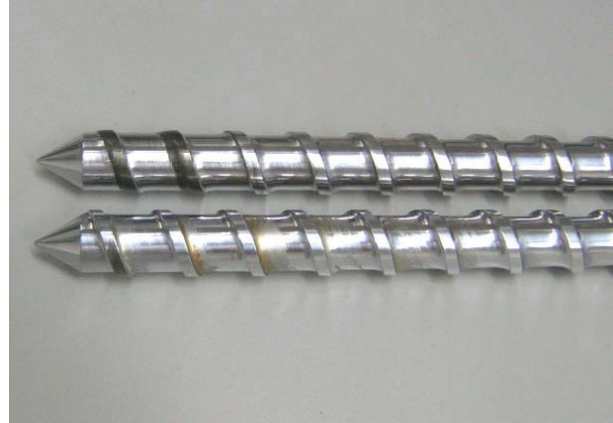
Abb. 28: Spitze der Schnecken 1:4 (oben) und 1:3 (unten) mit Abrasionserscheinungen
