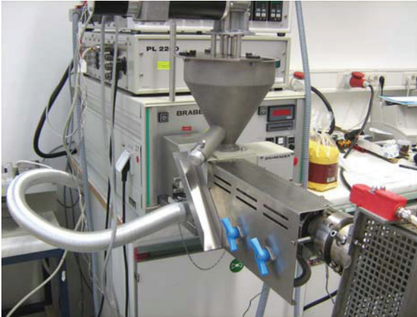
Abb. 27: Dosiertrichter mit Auslassöffnung; Kühlluftanschluss und Luftregelventile am Extruderzylinder
