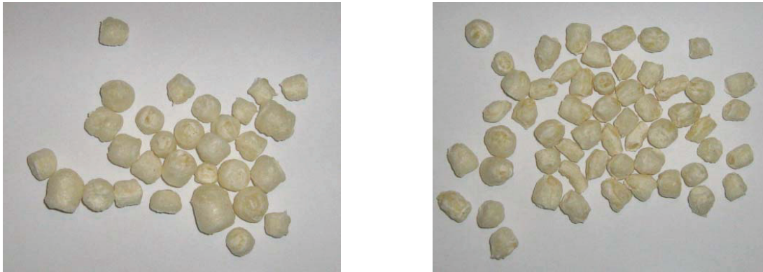
Abb. 29: Unterschiedlich stark expandierte Extrudate aus purem Weizengrieß des selben Versuchsdurchlaufs
