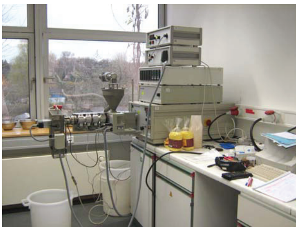
Abb. 25: komplett aufgebauter Extruder am DO- CORDER
