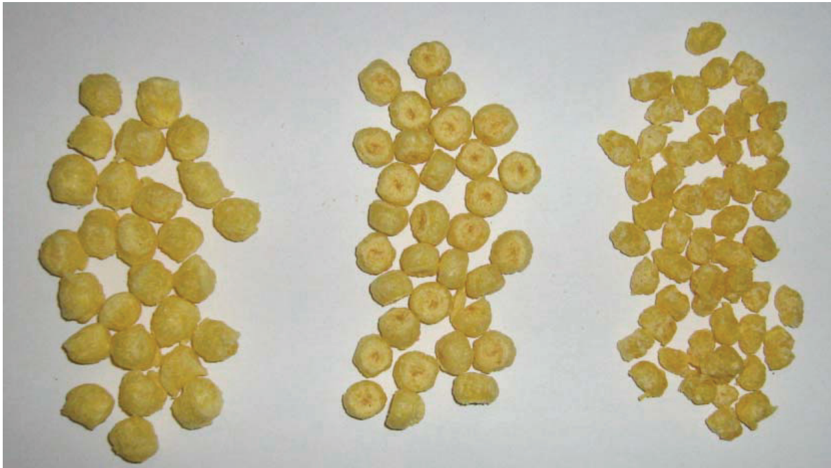
Abb. 31: Maisgrießextrudate mit ansteigender Feuchte
