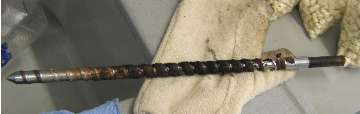
Abb. 35: Schnecke nach dem Festbrennen durch zu hohen Zuckergehalt in der Rohstoffmischung
