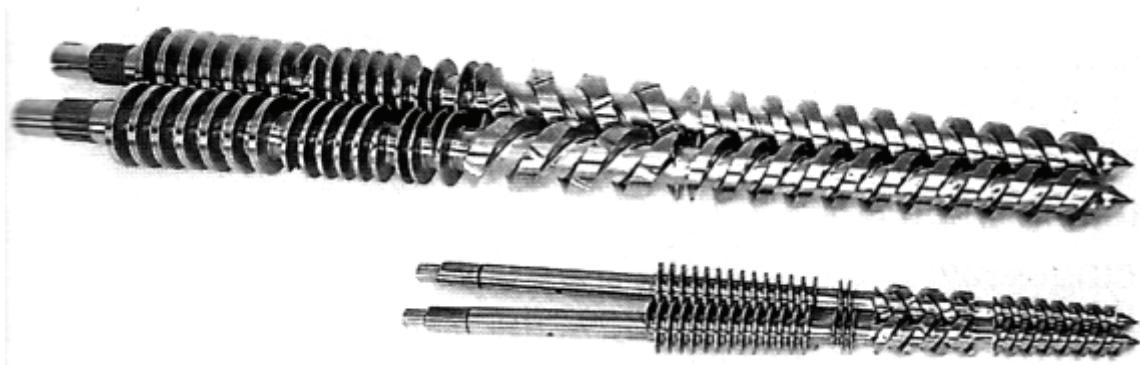
Abb. 17: Schneckenpaare von konisch gegenläufigen Doppelwellenextrudern (Greif et al., 2004)
