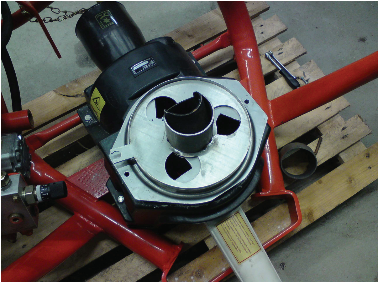
Veränderte Dosiereinrichtung nach den Umbaumaßnahmen 2008 Quelle: eigene Darstellung
