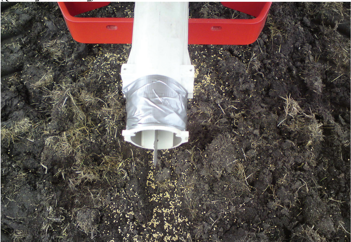
Abdichtung des Pendelrohres mit Gewebeklebeband, außerdem zusehen sind die überhöhten Düngermengen im Bereich der Fahrgasse. (Quelle: eigene Darstellung)
