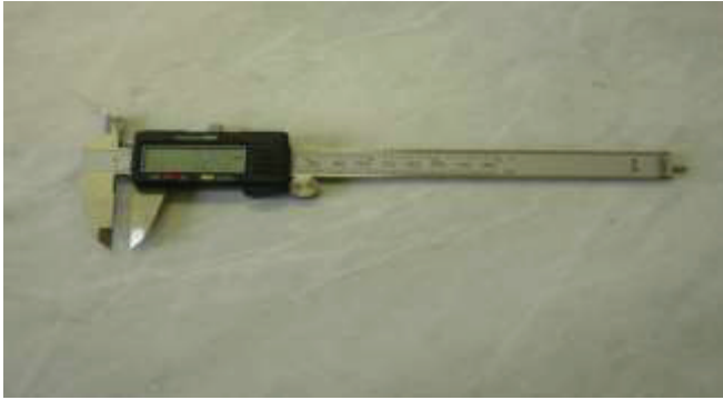
Abbildung 15: Digitaler Messschieber zur Wurzel- und Blattlängenmessung (Quelle: Eigene Darstellung)
