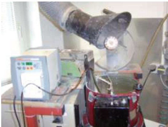
Abbildung 9: Pilliergerät der Saatzucht Steinach in Steinach (Quelle: Eigene Darstellung)
