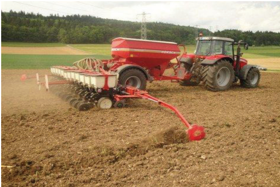
Abbildung 2: Aufgesattelte Maschine mit pneumatischer Düngerverteilung (Quelle: Horsch)
