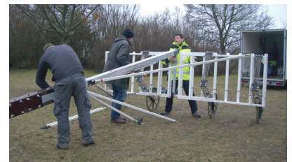
Abb. 40: Aufbau des Sonarmessanhängers für den Jeep, Foto: Dupke, 2011
