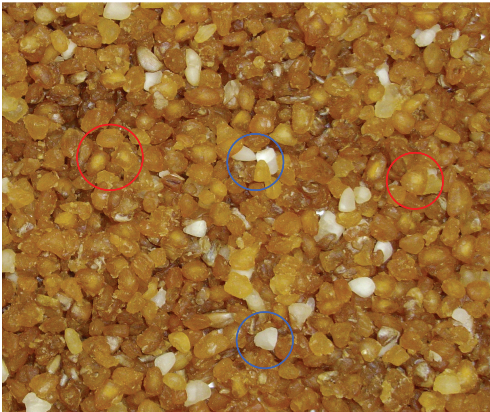
Abb. 18: Grütze mit zu niedrigem C-Wert von 173,77 min
