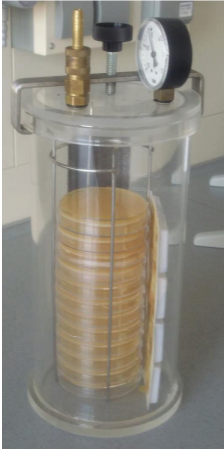
Abb. 2: Anaerobentopf mit Anaerocult und Petrischalen
