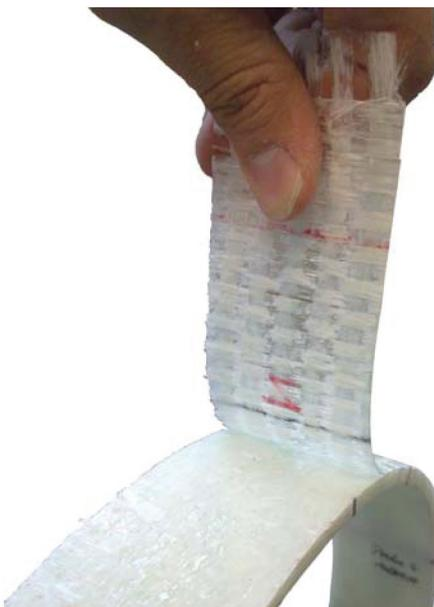
Bild 5.1. Abziehen des Zugbandes
