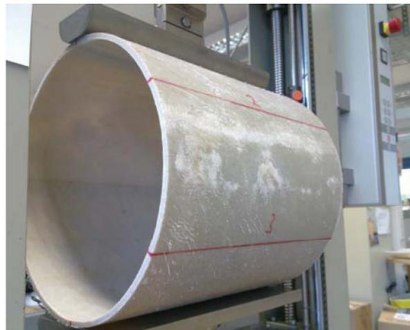
Bild 5.11. Eingespannte Probe für den Scheiteldruckversuch
