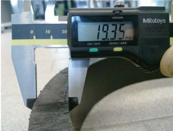
Bild 5.6. Wanddickenmessung an einem gebogenen Probekörper
