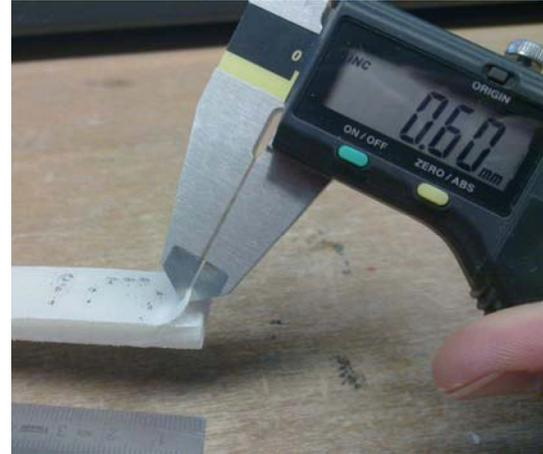
Bild 5.7. Messung der Innenbeschichtung eines Liners
