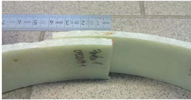
Bild 5.13. Zusammenpringen des Ringes durch innere Spannungen
