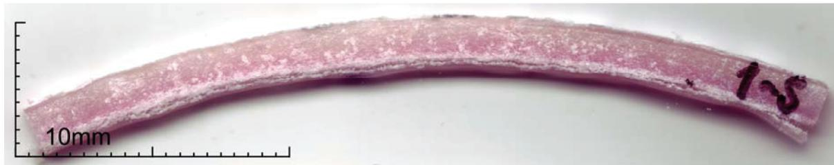
Bild 7.4. Feinschnitt der Probe 5 mit kleinen Poren
