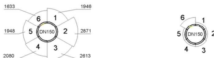
Bild 7.3. Darstellung der E-Module und der Wanddicken von Versuch 1
