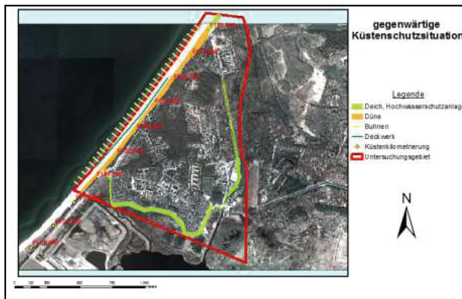
Abb. 64: gegenwärtig vorhandene Küstenschutzbauwerke auf Grundlage des Orthophotos 2007 - Quelle: eigene Erstellung auf Grundlage des Orthophotos 2007, bereitgestellt vom Landesamt für innere Verwaltung
