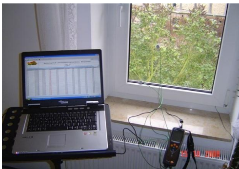
Abb. 8: Möglicher Aufbau einer U-Wert-Messung eines Kunststofffensters [32]
