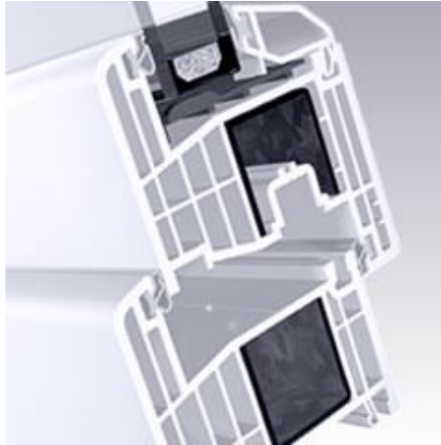
Abb. 17: Profilsystem S 8000 IQ mit 7 Kammern; Zweifach-Wärmeschutzverglasung und flächenversetzte Ausführung mit zweifach abgeschrägter Glasleiste
