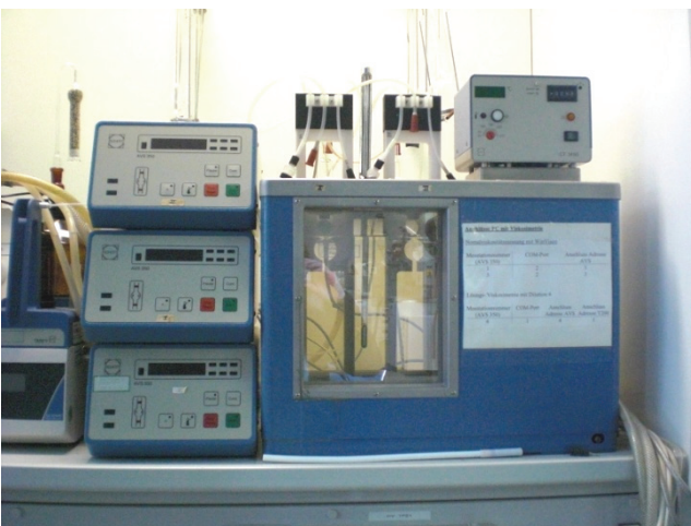
Abb. XIII: Viskosimetrie – Apparatur für Normalviskosimetriemessungen
