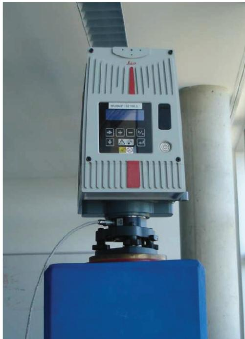
Abbildung 1 – Leica HDS6000, für diese Arbeit verwendetes Gerät
