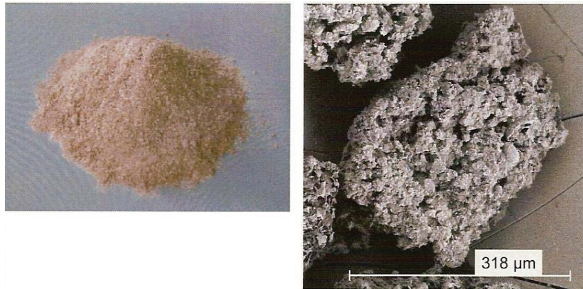
Abbildung 12: Schokoladenpulver und REM-Aufnahme von Feinwalzgut (Bühler AG, 2006)
