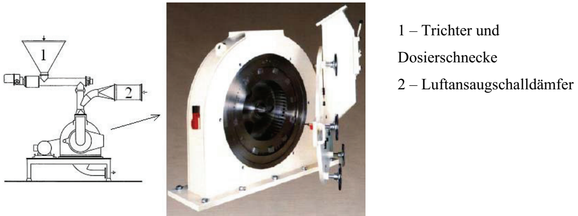
Abbildung 9: Prallmühle zur Zuckermahlung (Bauermeister Zerkleinerungstechnik GmbH, 2006)
