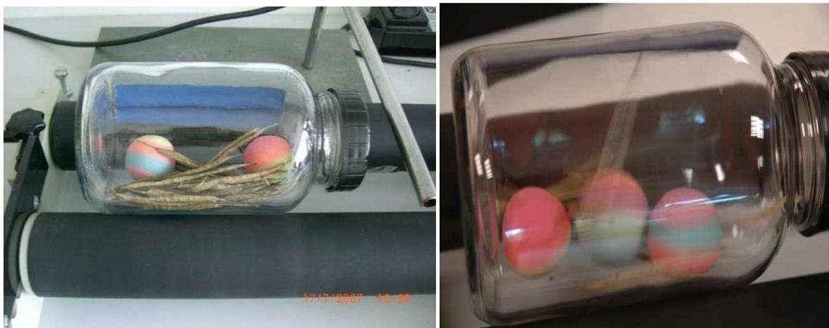
Abbildung 1: Prüfgefäß mit Gummikugeln (Quelle: Syngenta Agro Service Center)
