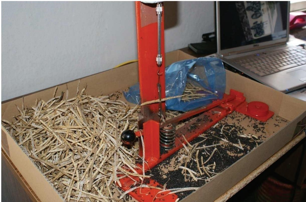
**Abbildung 5: Trägergestell mit eingespannter Schote (Quelle: Eigene Darstellung)**
