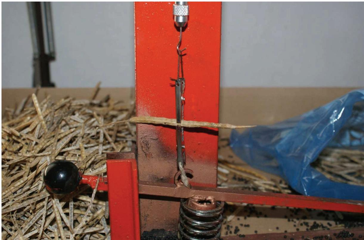
**Abbildung 7: Klemmen mit einer exakt eingespannten Schote (Quelle: Eigene Darstellung)**
