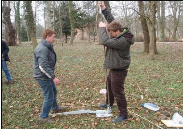
Abb. 26 Laufende Bodensondierung (Meyer, M., März 2010)
