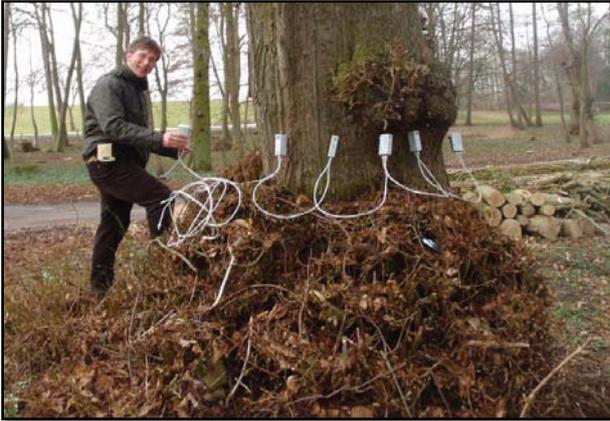
Abb. 127 Stev Austinat beim Aufbau der Untersuchung mittels ARBOTOM® (Eigene Aufnahme, März 2010)
