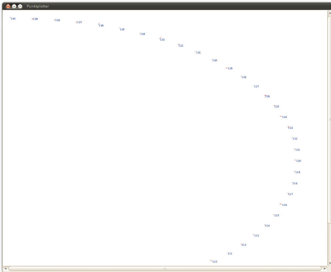
Abbildung C.6.: Simulierte Tachymeter-Messung (Verbesserungen 50-fach vergrößert)
