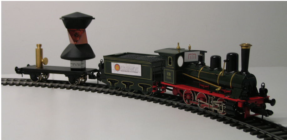
Abbildung 5.1.: Märklin-Modelleisenbahn mit GRZ4 -Prisma auf dem Anhänger
