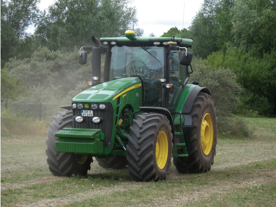
Abbildung 5.4.: John-Deere-Traktor mit StarFire-iTC -Empfänger (Dach) und Topcon HiPer Pro (rechter Außenspiegel)
