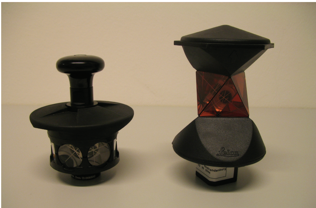
Abbildung 5.2.: 360°-Prisma von Trimble (links) und GRZ4 -Prisma von Leica (rechts)
