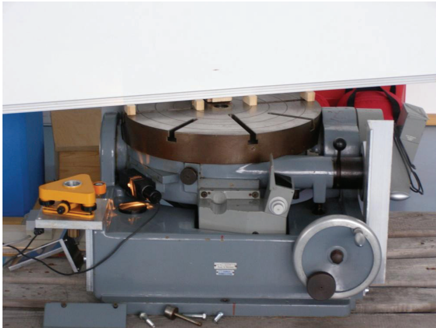
Abbildung 10: Drehtisch mit Kurbeln und Ableseeinrichtungen
