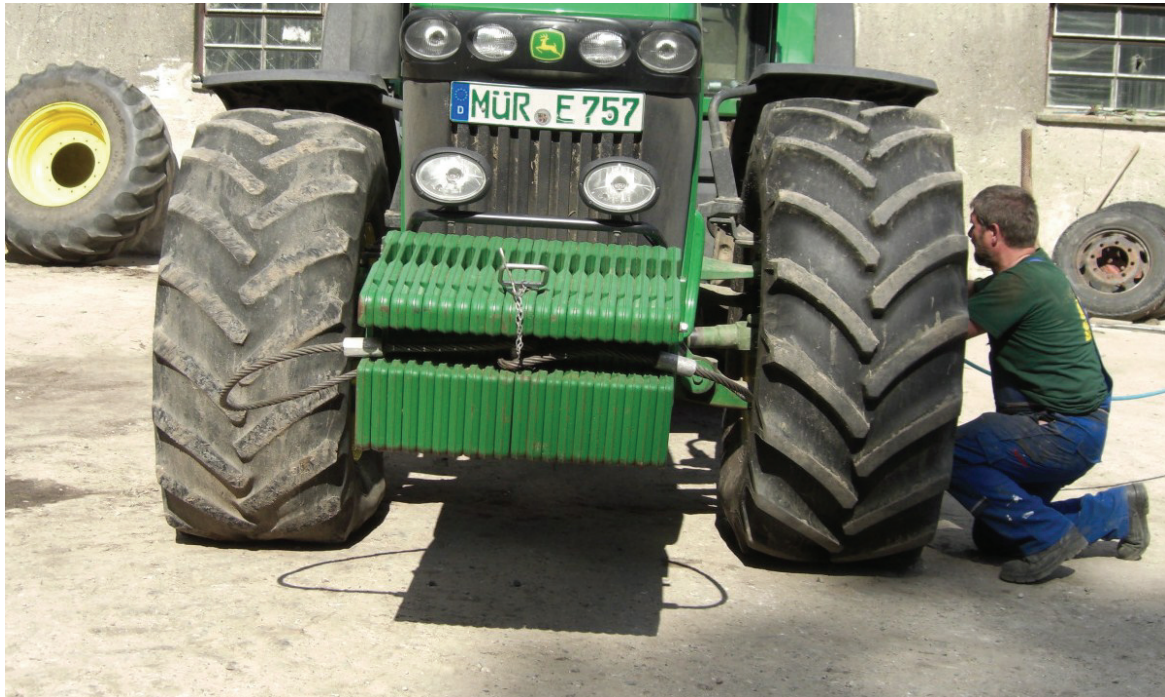
Abbildung 20: Vergleich Reifen glatt 0,9 bar, Reifen voll 1,5 bar
