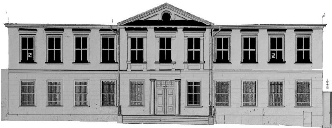
Abb. 6.11: Orthofoto der Südwestfassade aus Laserscandaten
