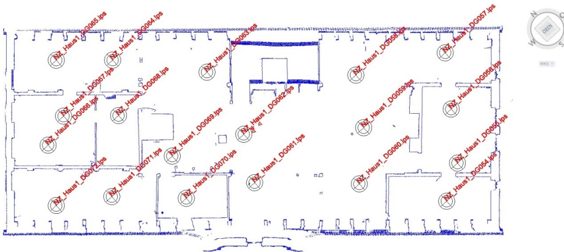
Abb. 5.5: Scannerstandpunkte im Dachgeschoss
