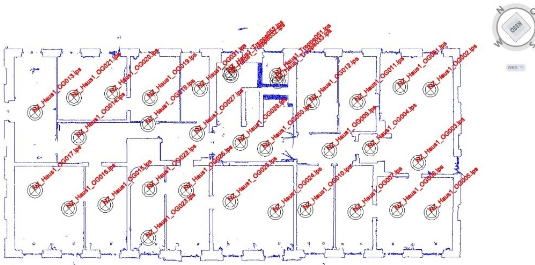
Abb. 5.4: Obergeschoss mit einer Übersicht der Scannerstandpunkte
