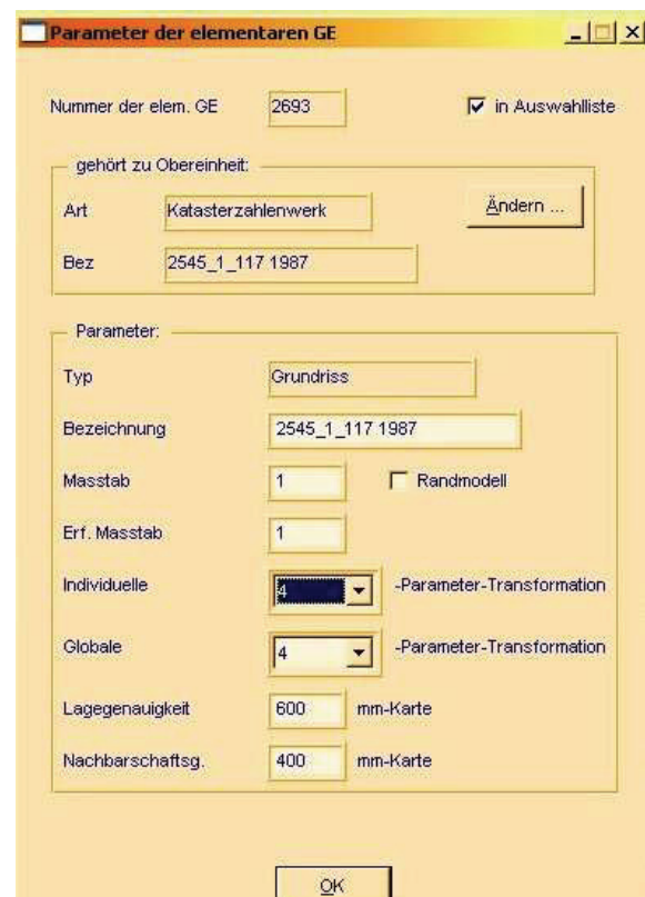
Abbildung 81: Wahl der gewünschten Transformation und Einstellung der Genauigkeiten für ein lokales System in Integris®
