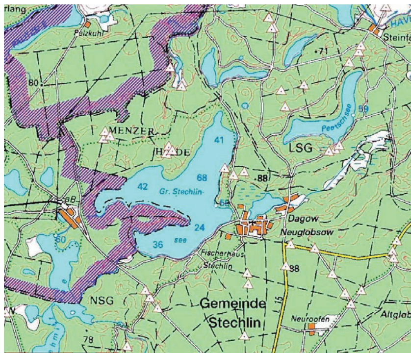
Abbildung 69: Auszug aus der TP-Übersicht mit Kreiskoordinaten und ETRS89/UTM-Koordinaten (Landkreis OHV, FD Vermessung)
