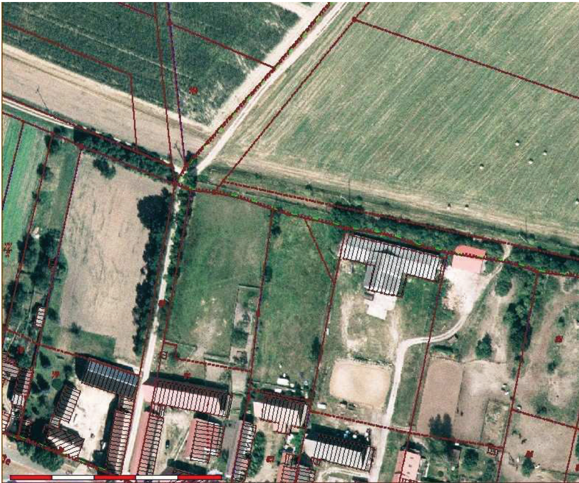
Abbildung 23: Verschiebung der ALK-Flurstücksgeometrie gegenüber der Örtlichkeit (Landkreis OHV, FD Liegenschaftskataster)
