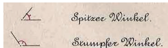
Abbildung 76: Kennzeichnung von spitzen oder stumpfen Winkeln an Gebäuden
