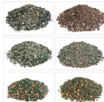
Abb. 26 : Einschichtdachsubstrat mit Recyclingbruch aus Ziegelsteinen (Quelle: Liesecke 2004)
