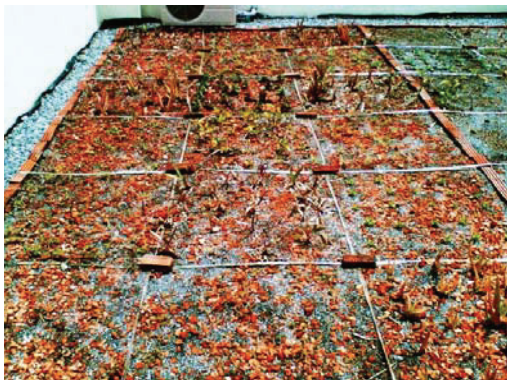
Abb. 78: Fläche 3 mit Grundsubstrat 10 % Humus und 10 % Ziegelbruch
