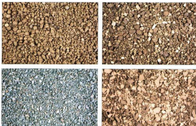
Abb. 25 : Einschichtdachsubstrat (Quelle: Liesecke 2004)
