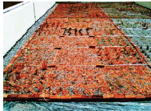
Abb. 79: Fläche 4 mit Grundsubstrat und 10 % Ziegelbruch
