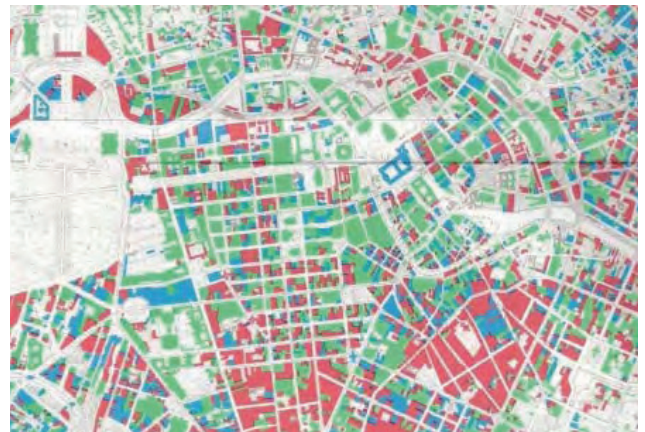
Abb. 79. Plan der Gebäudeschäden aus den Jahren 1945/1947, Legende: grün - beschädigt, wieder aufbaufähig, blau - durch Brand zerstört, rot - durch Sprengwirkung zerstört
