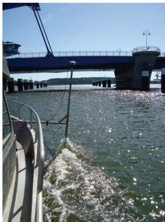
Abbildung 18: Messaufbau - Sidescan Sonar
