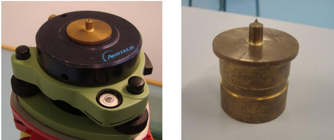
Abbildung 7.2: Spezielle Zieleinrichtung
