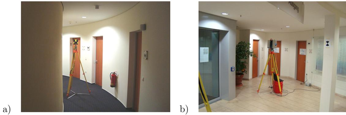
Abbildung 5.4: a) Verteilung der Zielmarken, b) Scannermessung HDS6000
