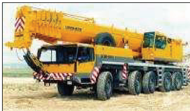
Abb. 28: Mobilkran LTM 1400/1 von Liebherr nach [B28]
