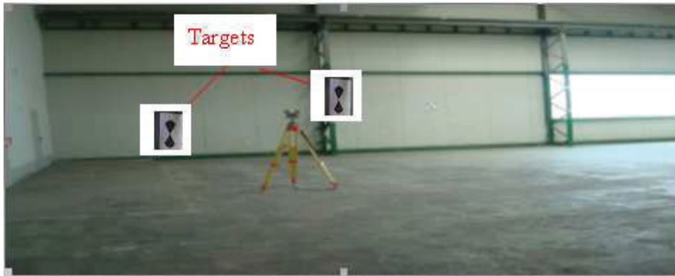
Abb.12.3: Targets an die Wand , Stütze
