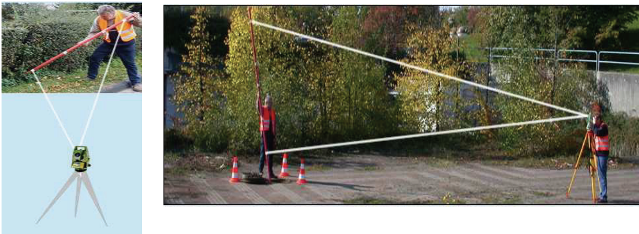
Abb.6.2: Messung mit Kanalmessstab
