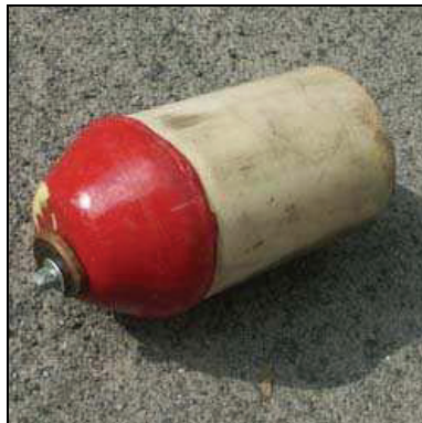
Abb. 2.2.3.3: Molch mit eingebautem aktivem Magnetfeldsender [lind08]
