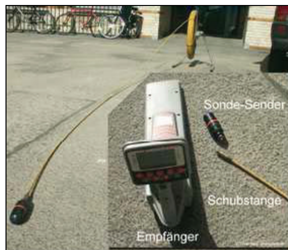
Abb. 2.2.3.2: Schubstange mit Sonde [lind08]
