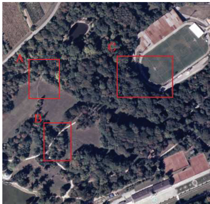
Abbildung 34: Orthophoto vom Schlosspark Eisenstadt mit gekennzeichneten Testgebieten, mit Hilfe dessen die Grenze zwischen Boden und Nicht-Bodenpunkten gesucht wird: (A) Niedrige Vegetation, (B) Hohe Vegetation, (C) Spielplatz.
