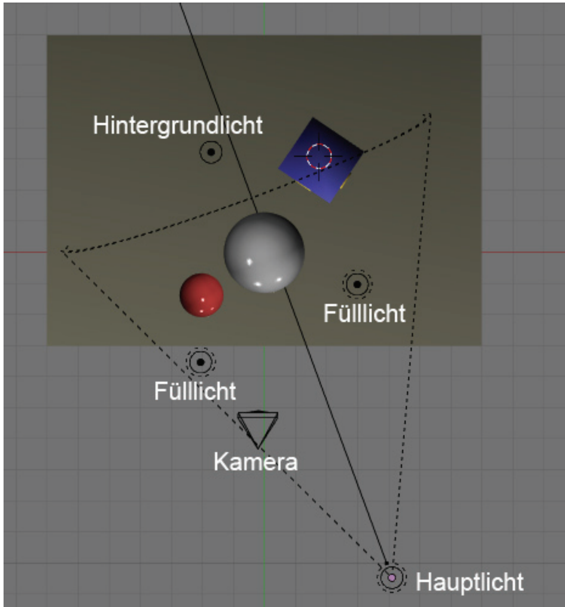
Abb. 4.11: Aufstellung der 3 Punkt Beleuchtung
