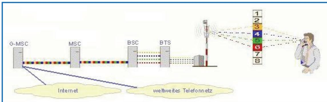
Abbildung 4.a: Funktionsübersicht Datenübertragung
