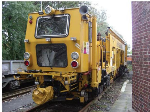
Abb. 32: Gleisricht- und Stopfmaschine der HOCHBAHN (Fa. E M S Gleisbau)
