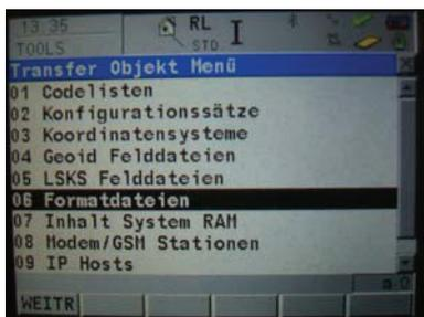
Abb. 83: Übertragung von Objekten aufs Mess-Instrument
