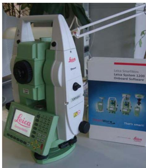
Abb. 3: Tachymeter TCRP 1201+
