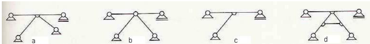
Abb-7.3: einfache Sprengwerke [Alois Mucha Holzbrücken S.37]
