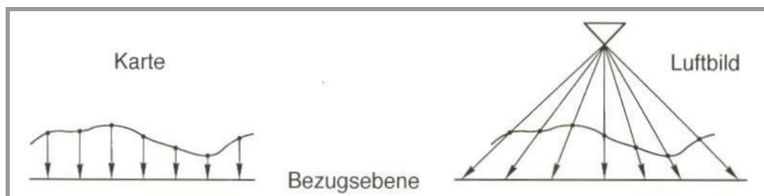
Abb. 6.9: Abbildung des Geländes in Karte und Luftbild. Links: Parallelprojektion der Karte; Rechts: Zentralprojektion eines Luftbildes [1]
