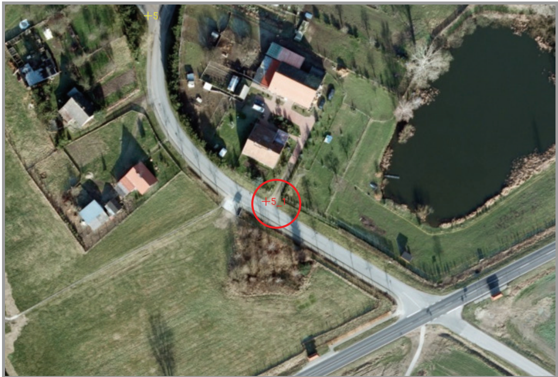
Abb. 6.2: Beispiel für natürlichen Passpunkt - Übersicht [Blom Deutschland GmbH]
