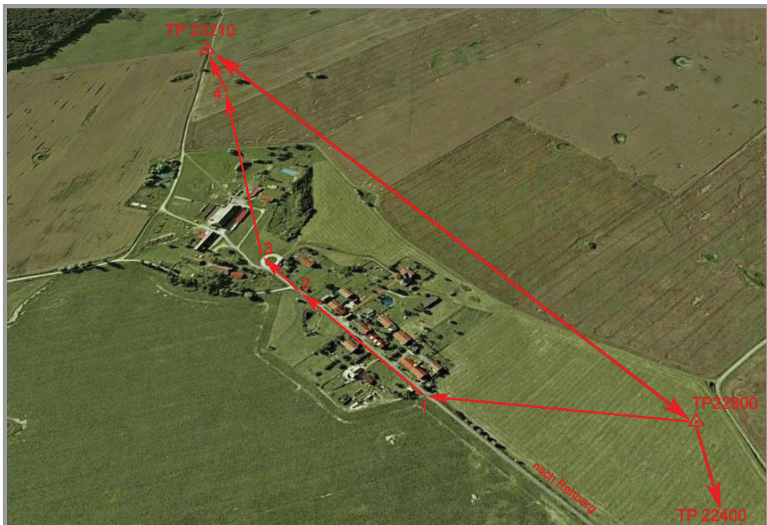
Abb. 4.3: Übersicht über den Winkel- und Streckenzug [32]
