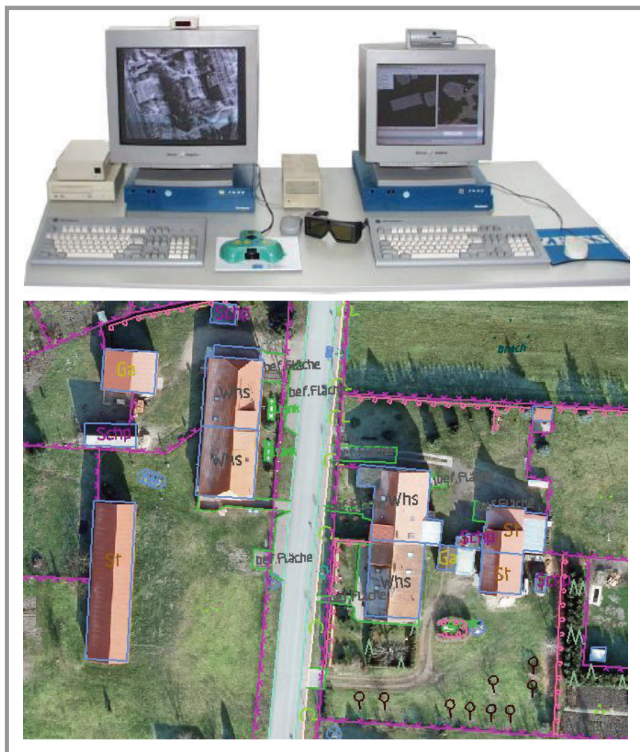
Abb. 6.6: Stereoskopische Luftbildauswertung - Arbeitsplatz u. Ergebnis [Screenshot]
