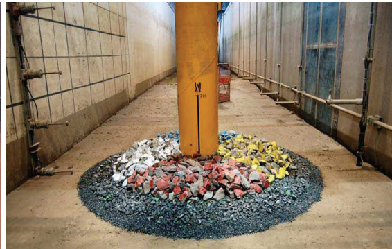
Abb. 35: Kolksicherung an einem Monopile [36]
