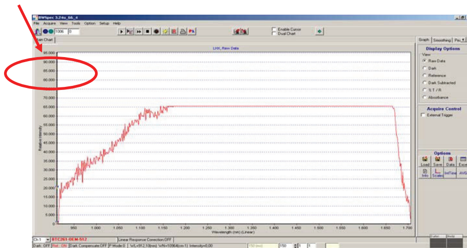
Abbildung 19: Programm BWSpec, Referenzmessung am Weißstandard mit zu hoher Integrationszeit, Übersteuerung des Signals
