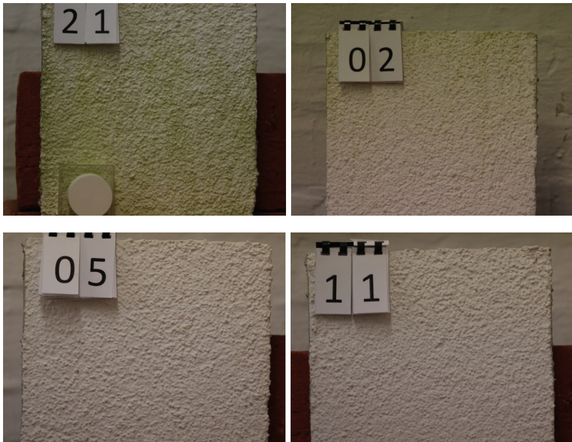
Abbildung 35: Bewitterte Proben von WDVS-Elementen an der Hochschule Wismar im Rahmen der Forschungskooperation
