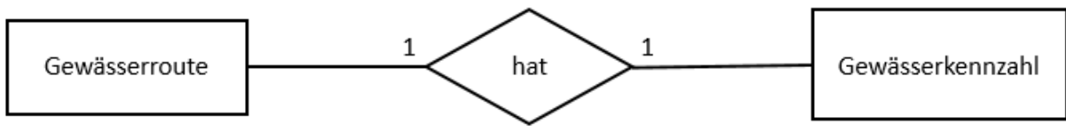
Abbildung 15 - ER-Diagramm für die Beziehung Gewässerroute - Gewässerkennzahl
