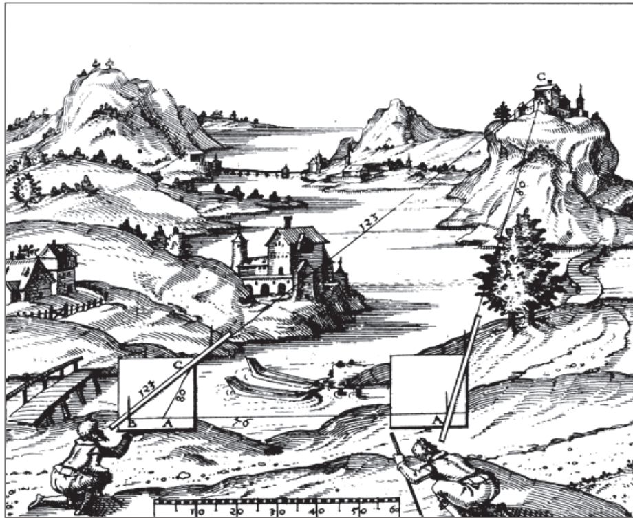
Abbildung 02 Zublers Messtisch, Zubler 1625 (Vollrath, 2004, S. 8, Q. [9])
