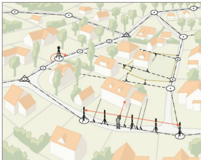
Abbildung 06 Prinzip der Orthogonalmethode im Netz der Polygonzüge (Seeberger, 2001, S. 61, Q. [8])
