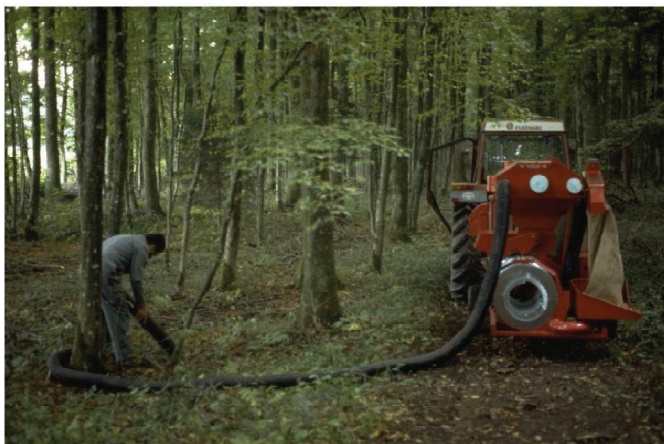
Abbildung 6: Maschinelle Ernte mit Sauggerät „Tonutti“ (proQuercus, 2010)
